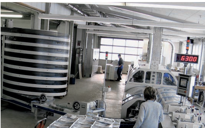
Der Kolbus-Ratiobinder mit einer Leistung von 8000 Takten pro Stunde. Bei klebegebundenen Produkten setzt Bückers fast ausschließlich PUR-Leim ein, der gerade bei schwierigen Produkten höhere Prozesssicherheit gewährleisten soll.
