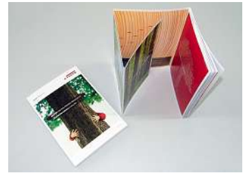
Der beschnittene Planobogen, das gerillte und gefalzte Zwischenprodukt »Umschlag« und die vollendete, in einem Klebebinder mit Kopf- und Fußbeschnitt sowie mit Hilfe eines Frontschnittagregats gefertigte Klappenbroschur.
