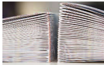
Qualitätsunterschied in der Rückensteigung: dieselbe Anzahl gefalzter Bogen – rechts ohne, links mit einmaliger Längspressung.
